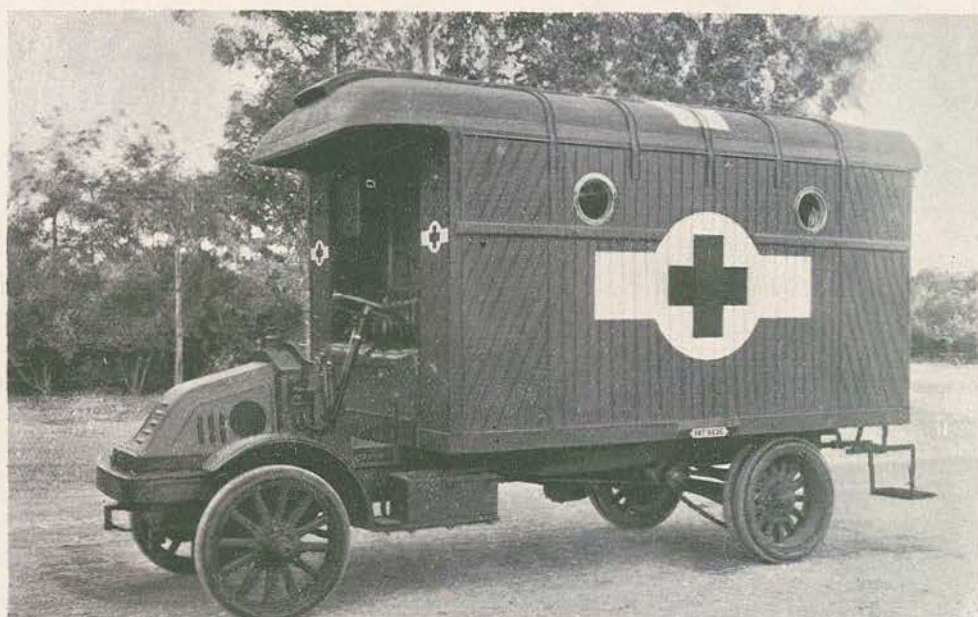
Viatura sanitaria para o transporte de feridos, da invenção do sr. João Guimarães Carreira. (Sobre chassis Keally).
