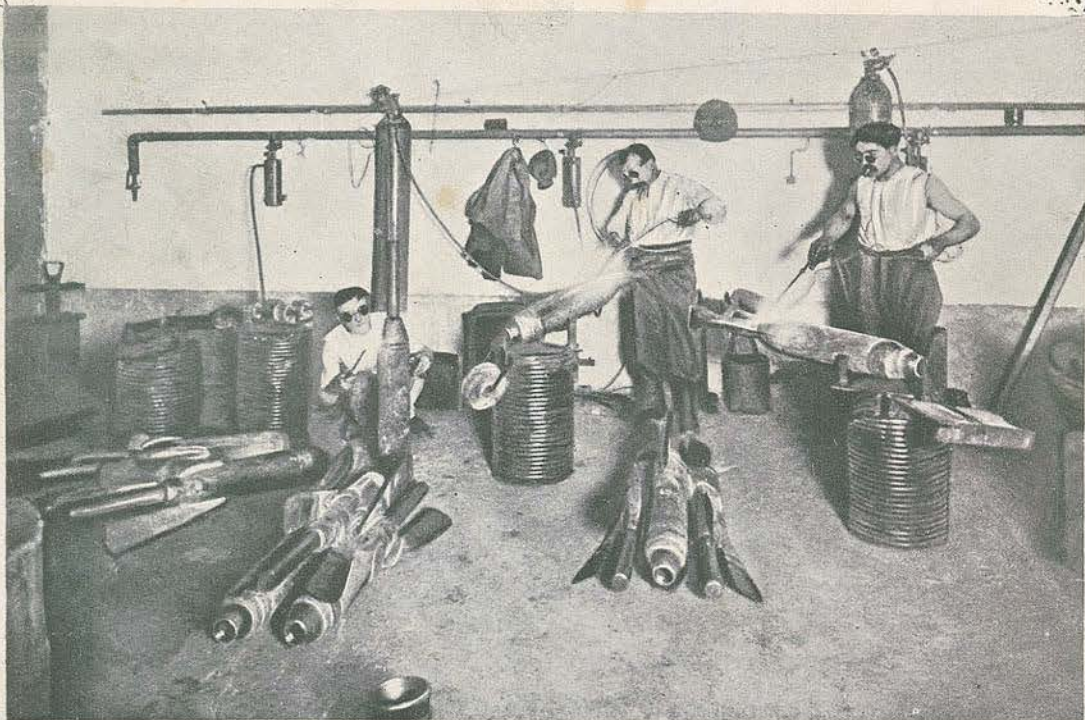
Fabrico de torpedos aereos em França. —Soldando diversas peças dos torpedos por meio de maçaricos.
