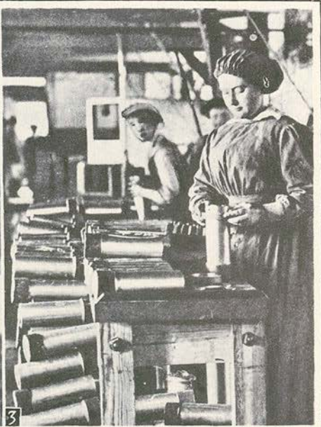
Verificando a medida dos envolveros das granadas
