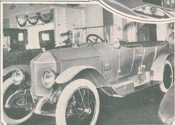
2. No tipo de chassis 26 H. P. que contem mise en marche electrica e bomba para prensa mecanica. —3. Tipo «Sport» capota invisivel sendo os metaes em prata de lei, carrosserie sport por Van den Plas chassis 18 H. P. metalurgico.—(Clilchès Benoitel).
