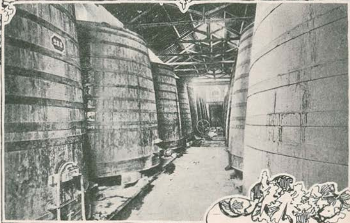
1—Vista exterior das adegas de Rio Frio 2—A casa de distillação e ratificação de alcool 3—Os balseiros de 60.000 litros das adegas de Rio Frio
