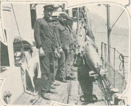
O torpedo entrando no tubo carcassa para lançamento
