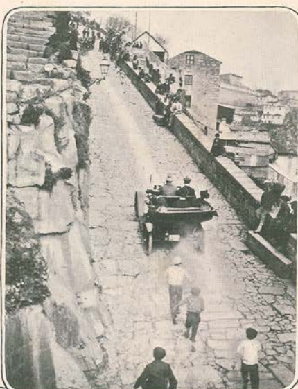
O automovel Ford que subiu em 32segundos a rampa da Corticeira no Porto, a qual tem o declive de 29 %, e uma extensão de 300 metros
