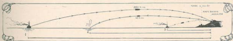
Estado actual da nossa defeza: 1—10,500 metros: alcance para ataque das peças de 30,cm 5 de qualquer couraçado de esquadra 2—7000 metros: alcance eficaz das peças de 15,cm tiro rapido. 3—Distancia a que precisa approximar-se um couraçado para a couraçado poder ser fuada pelas peças de 15,cm
