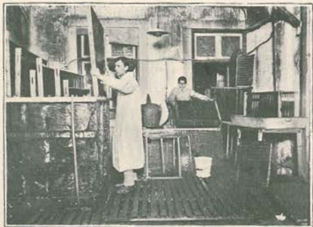
1 — No quarto escuro: a revelagem que se consegue fazer com a maxima rapidez obtendo-se mil metros de fita n'uma hora 2—A lavagem das fitas
