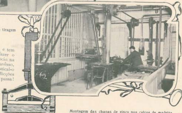
Montagem das chapas de zinco nos calços de madeira
