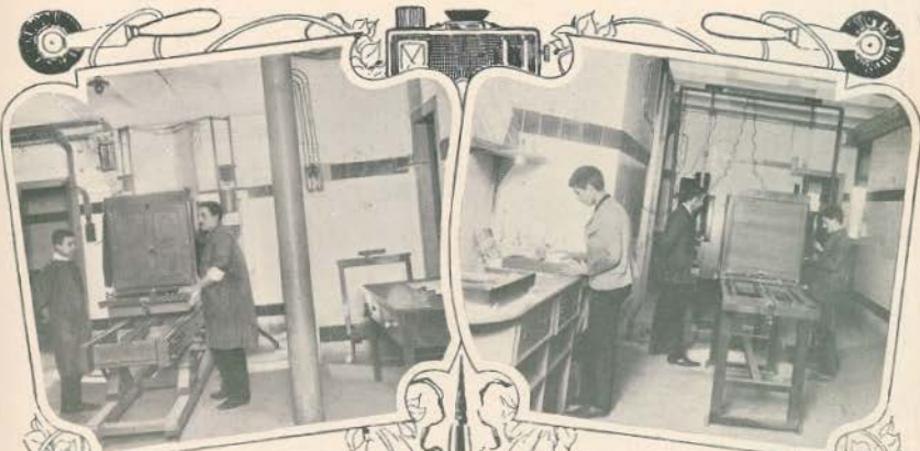
Machina photographica n.º 1, onde se fazem os clichés a meia tinta
