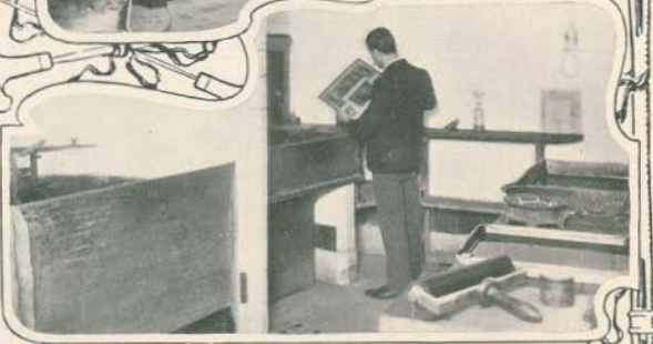
Impressão das chapas de zinco —Preparação e desenvolvimento das chapas de zinco (CLICHÉS DE ROCAFULL)
