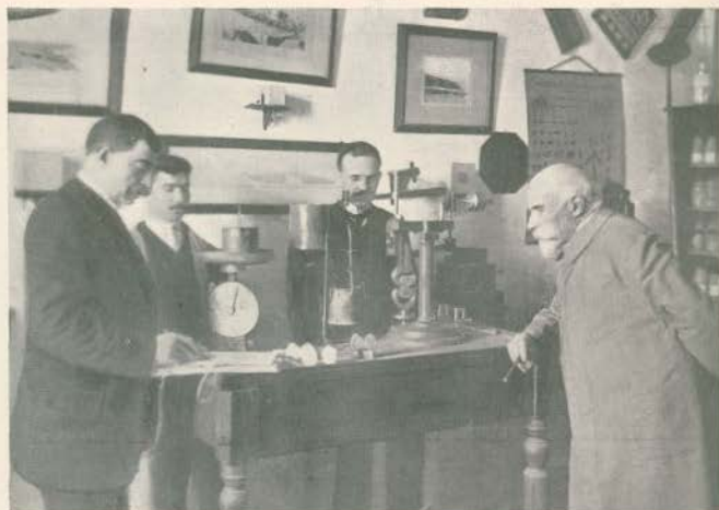
Ensaio de flexão de argamassas, na machina Amsler-Lafon, de 5 mil kilos
