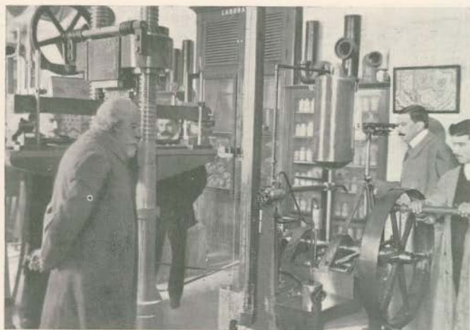
Ensaio de flexão na machina Amsler-Laffon, de 250 mil kilos
