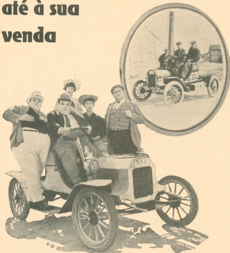
OS PRIMEIROS AUTOMÓVEIS. Fortes e feios. Motor de 2 cilindros. Lubrificação por chapinhagem. Inflamação de martelos. *Mise en marche* por manivela ao lado do estribo
