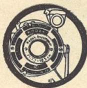
3 Focagem pelo des- locamento do anel de objectiva
