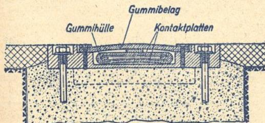
Fig. 1.—Secção de uma das travessas de contacto.—Kontaktplatten (placas de contacto, Gummibelag (cobertura de borracha)
