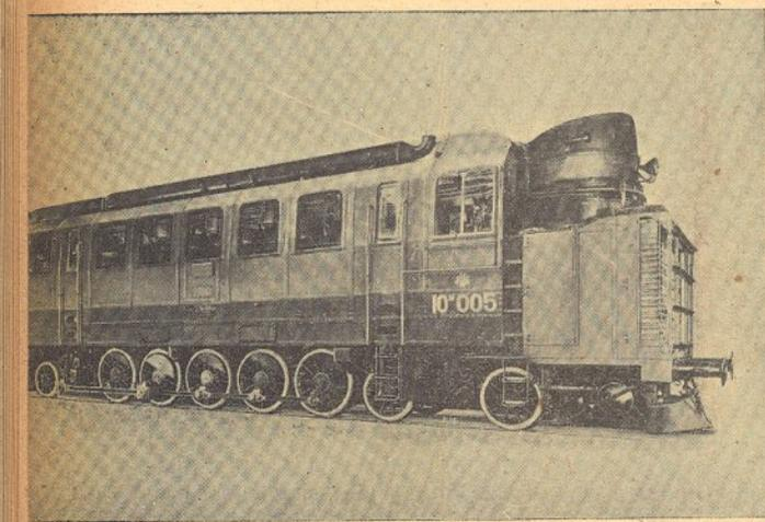
Figura 4—Locomotiva Diesel do tipo 2 E 1 com engrenagem. Com uma potência de 1.900 HP desenvolve 10 km/hora. Força de tracção 30.000 k. Pêso completo em serviço 151.000 k. O combustível dos depósitos chega para 20 horas de serviço. O pêso duma locomotiva a vapor de rendimento correspondente é de cerca de 142.000 k. e a provisão de água chega apenas para 5 horas de marcha
