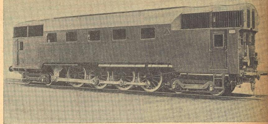
Figura 3—Locomotiva Diesel do tipo 2 D 2 com engrenagem, potência 1.450 HP. Velocidades 14, 26, 50 e 96 quilómetros/hora. Força de tracção 22.700 quilogramas. Pêso completo em serviço 148.000 quilogramas. Destinada para combóios rápidos
