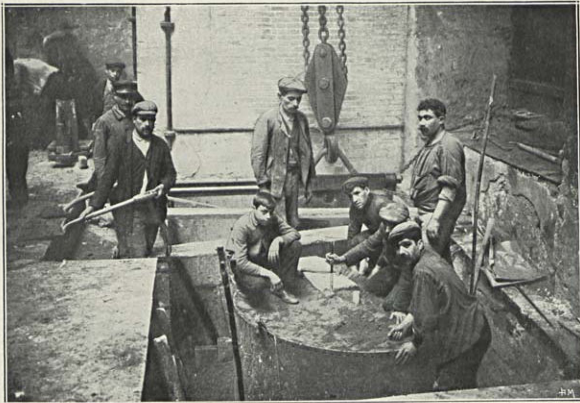
Na officina de fundição do Arsenal do Exercito em Santa Clara — A fundição da estatua de Joaquim Antonio de Aguiar, destinada á cidade de Coimbra
