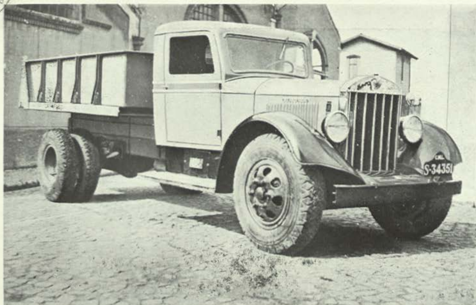
Novos camiões basculantes do Serviço de Transportes Gerais carroçados nos Serviços Industriais — Carga útil, 5.000 quilos
