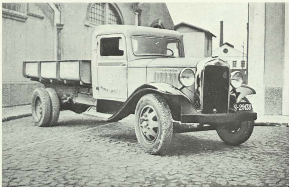
Novas camionetas basculantes do Serviço de Transportes Gerais, carroçadas nos Serviços Industriais — Carga útil — 2.500 quilos
